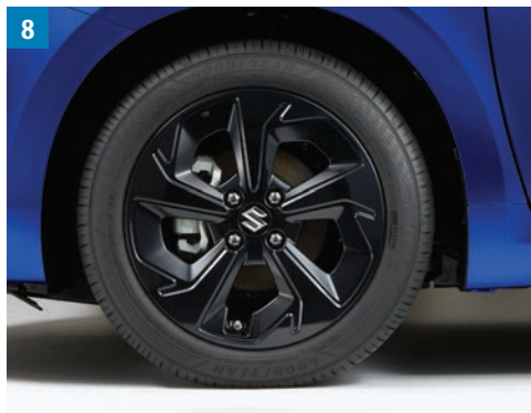
8 | Легкосплавний диск 16 дюймів Легкосплавний диск 6Jx16" для шин 185/55R16. Такий самий дизайн, як в оригінальних дисків для GL+. Чорний Арт. № 99277-70T00-ZJ3
